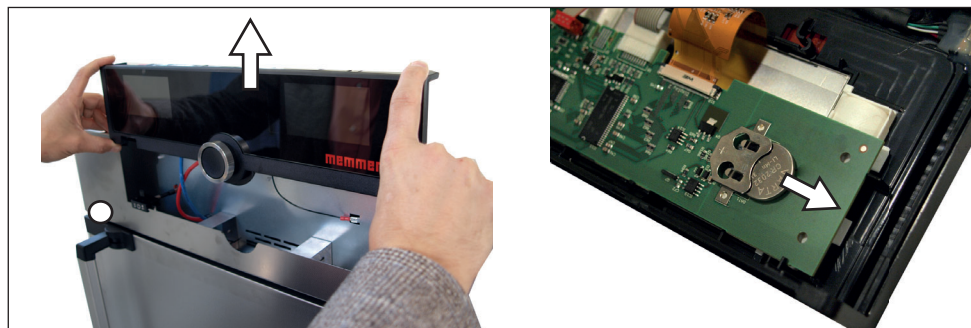
afb. 34 Het verwijderen van de lithiumaccu
